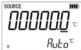
Рис. 3.2-1 — автоматическая компенсация холодного спая
