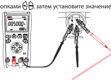
(Рис. 3.4-1 — подключение RTD к клеммам передней панели)
