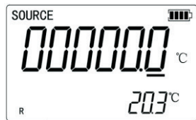
Рис. 3.2-2 — текущее значение компенсации 20.3°C
